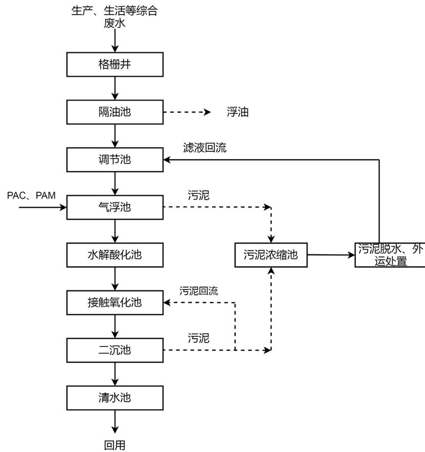
图 4-2 项目废水处理工艺示意图
