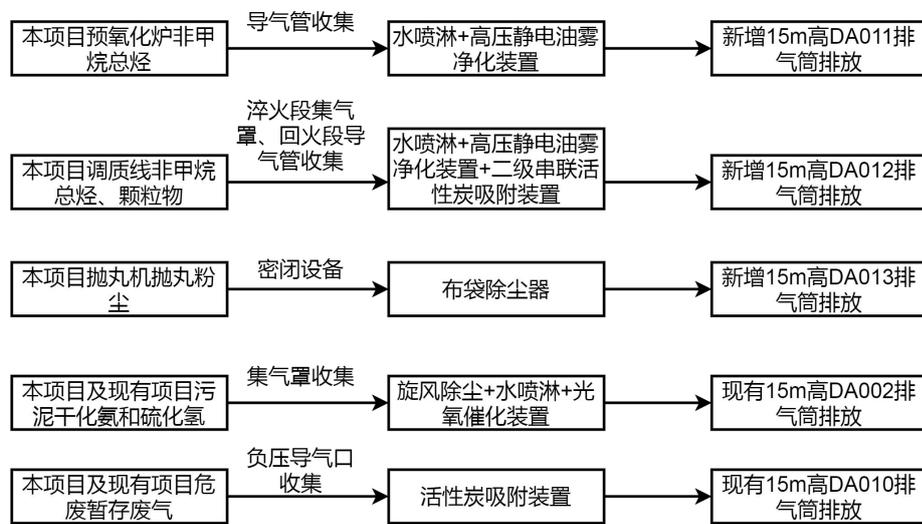
图 4-1 项目废气收集、处理示意图
