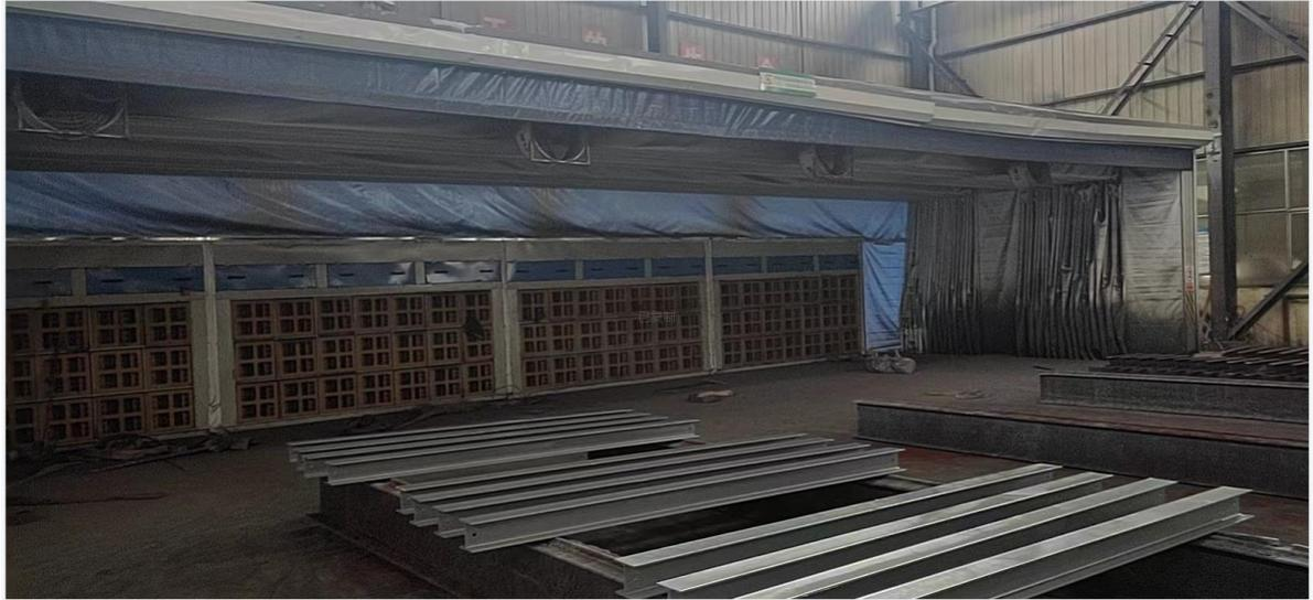
图4-2项目配套喷漆房（内设有干式滤纸过滤+滤棉过滤）
